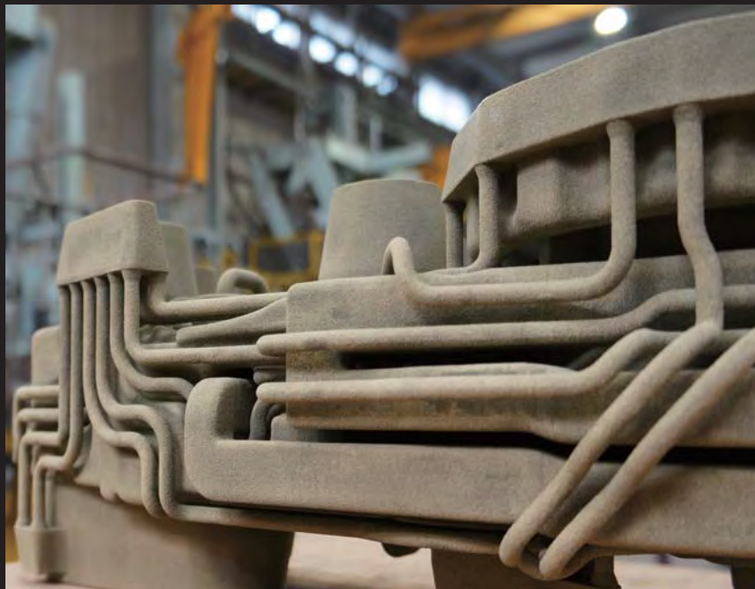
< 3Dプリンタで作製した中子サンプル > 全体に流路(直径8mm)を張り巡らせている 3Dプリンタ以外での作製は困難
