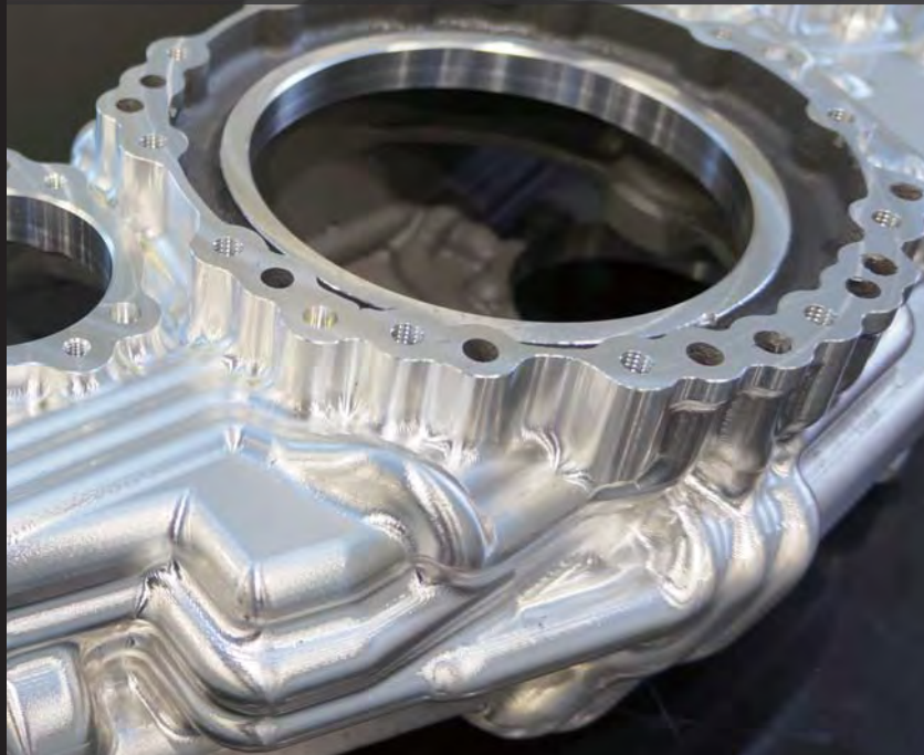
< 上記鑄物の外部形状を総切削した加工サンプル > 鑄物では実現困難な薄肉(最薄部2.0mm)を実現 寸法精度は鑄物の10倍以上
